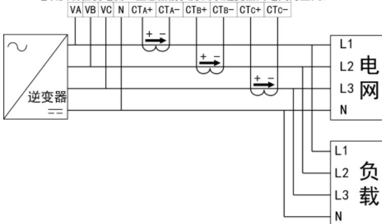
8.1.2 电表安装在并网侧(互感器箭头方向以电网向逆变器为正向)
