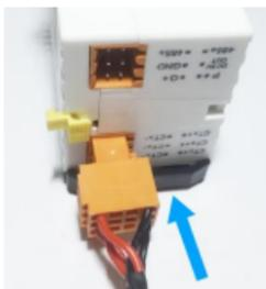
**注意：互感器绝对不允许出现开路状态，务必先将互感器接头接到电表上再卡到线路上，以免引起安全事故**
